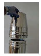
Montirajte konusni završetak na kraju dimnjaka. ICS ima obezbeđen odvod kondenzata kao i kapilarne brane na spojevima tako da na konus nije potrebno montirati poklopce protiv padavina.
